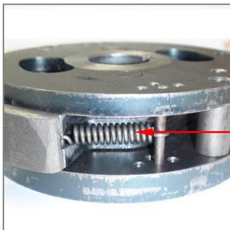
Rückholfeder (2x vorhanden pro Messerbremse, 180 Grad versetzt)
