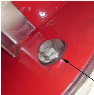
Achten Sie dabei darauf, dass innen unter der Unterlegscheibe der Kufenführung die entsprechende Gummischeibe wieder eingebaut wird.
