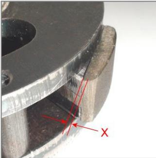
Die Mindestbelagdicke „X“ am Auslauf des Belages beträgt 1.0 mm.
