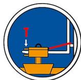
Einstecktasche und Gabelstaplerzinken mittels Arretierungsschraube und Sicherungskette oder Seil sichern.
