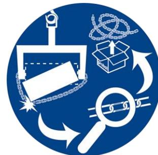
Wenn die Last in die Lastsicherungskette fällt, muss die Kette fachgerecht geprüft und bei Bedarf ersetzt werden.
