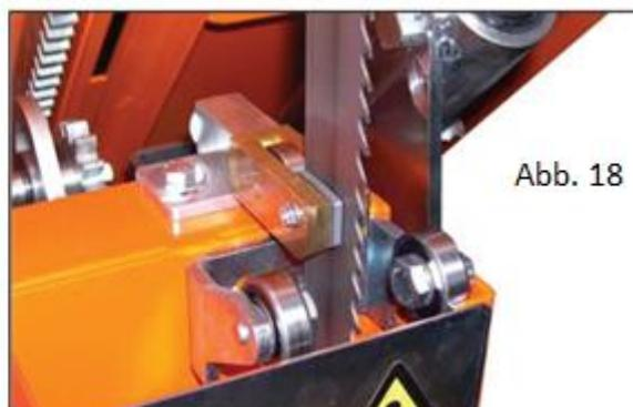
Wenn das Kugellager hinter dem Sägeband eine tiefe Rille hat, muss es ersetzt werden:
