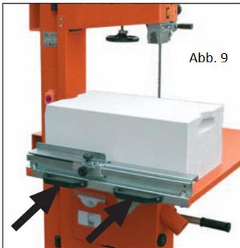
Stellen Sie am Ende des Schneidvorgangs sicher, dass das Sägeband vor dem Entfernen der Zuschnitte stillsteht:
