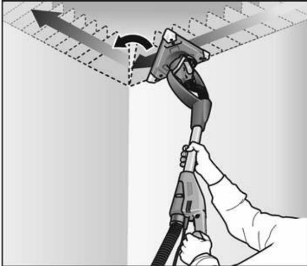
Da der Dreieck-Schleifkopf drehbar gelagert ist, kann bis in die Ecken von Wand/Decke geschliffen werden.
