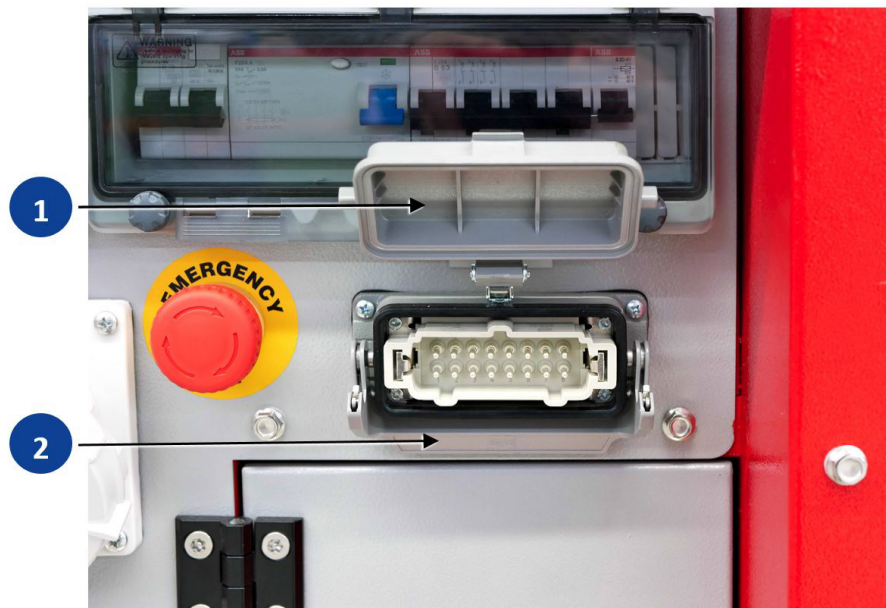
Abb. 8-8 Fernstarteinrichtung mit HARTING®-Steckdose
